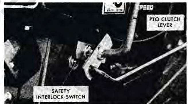
FIG. 3 — P.T.O. CLUTCH LEVER & INTERLOCK SWITCH
