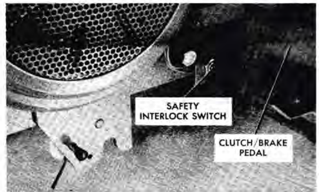
FIG. 2 — CLUTCH/BRAKE PEDAL INTERLOCK SWITCH
