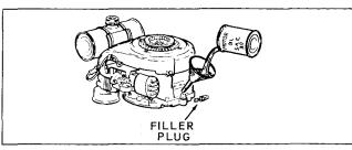
NEVER FILL THE GAS TANK WHILE THE ENGINE IS RUNNING. DO NOT MIX OIL WITH GASOLINE.
