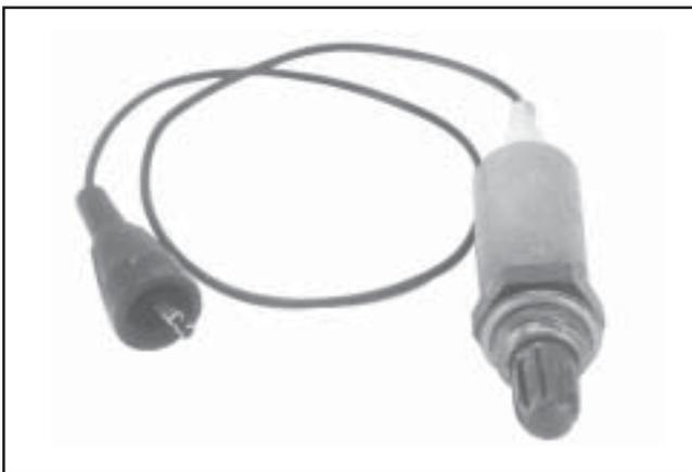
**Figure 5B-11. Oxygen Sensor.**
