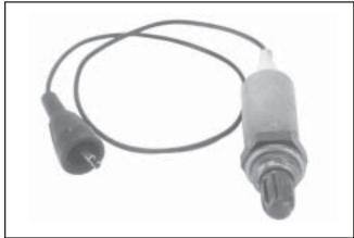
Figure 5B-11. Oxygen Sensor.
